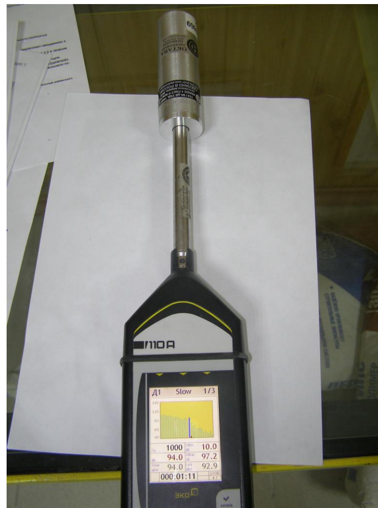
Фото 2. Калибровка шумомера при помощи калибратора акустического типа АК-1000
