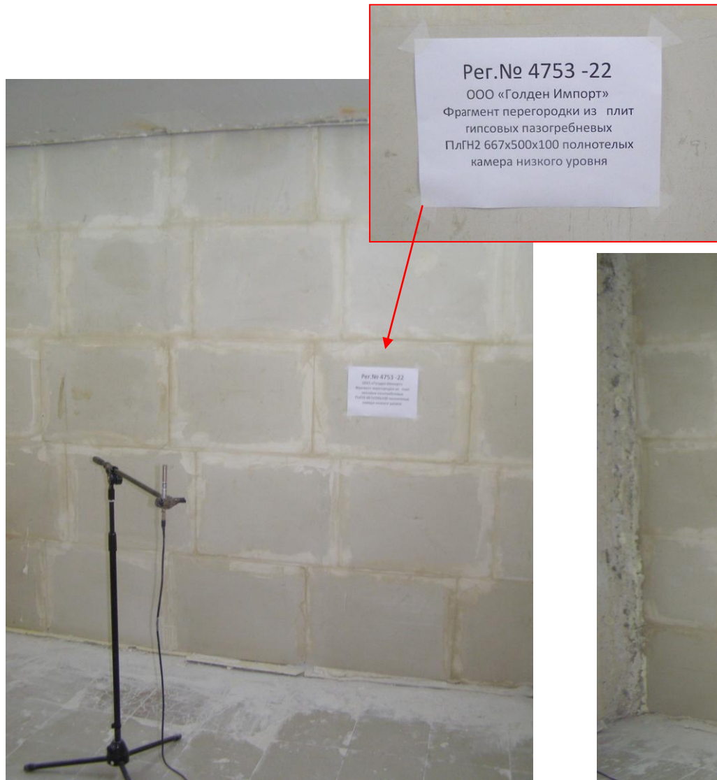
Фото 3. Камера низк. уровня, (испытание перегородки рег. № 4753-22 в акустической камере)
