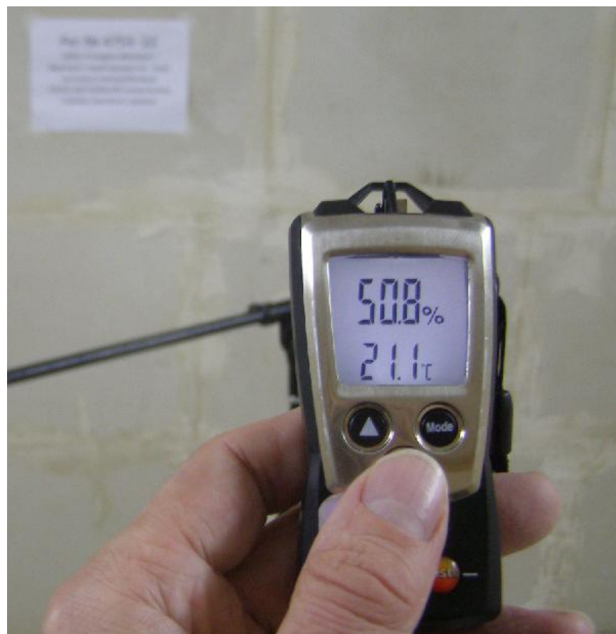
Фото 5. Испытания проводили при температуре окружающего воздуха 21,1°C и средней влажности 50,8 %, (испытание перегородки регистрационный № 4753-22 в акустической камере)
