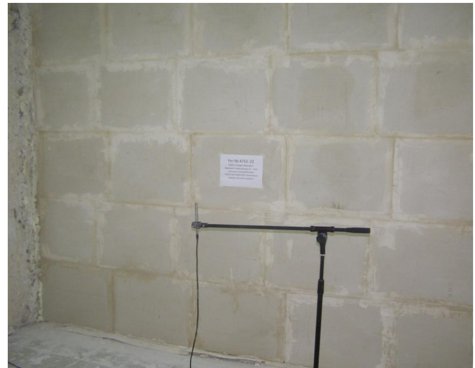
Фото 4. Камера высок. уровня, (испытание перегородки рег. № 4753-22 в акустической камере)
