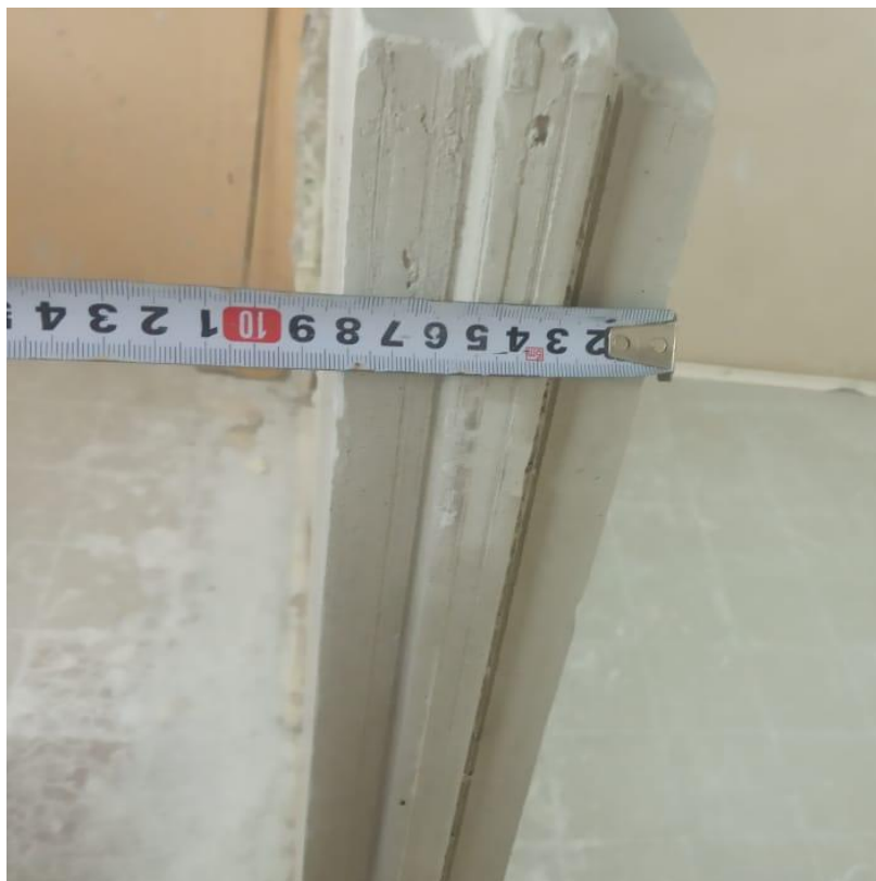
Фото 1. Изготовление фрагмента перегородки в акустической камере, (плиты гипсовые пазогребневые полнотелые ПЛГН2 размером 667x500x80)
