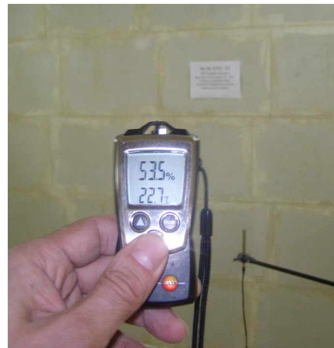
Фото 2. Испытания проводили при температуре окружающего воздуха 22,7°С и средней влажности 53,5 %, (испытание перегородки регистрационный № 4751-22 в акустической камере)
