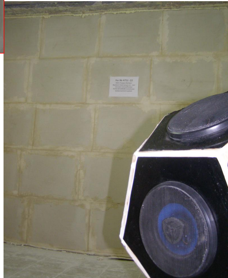
Фото 4. Камера высок. уровня, (испытание перегородки рег. № 4751-22 в акустической камере)
