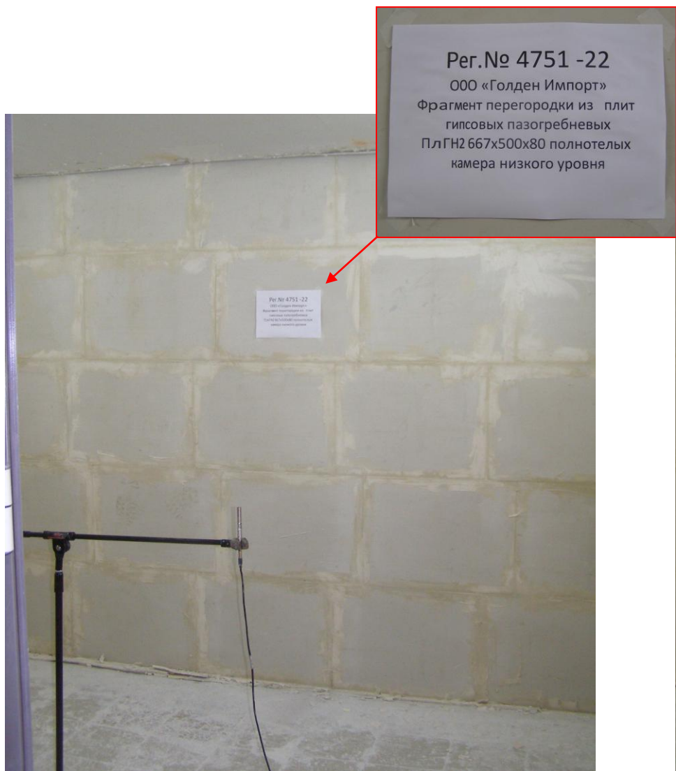
Фото 3. Камера низк. уровня, (испытание перегородки рег. № 4751-22 в акустической камере)
