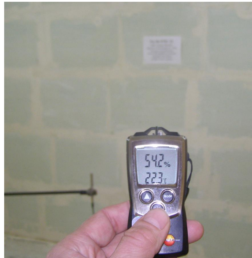
Фото 2. Испытания проводили при температуре окружающего воздуха 22,3°С и средней влажности 54,2 %, (испытание перегородки регистрационный № 4750-22 в акустической камере)
