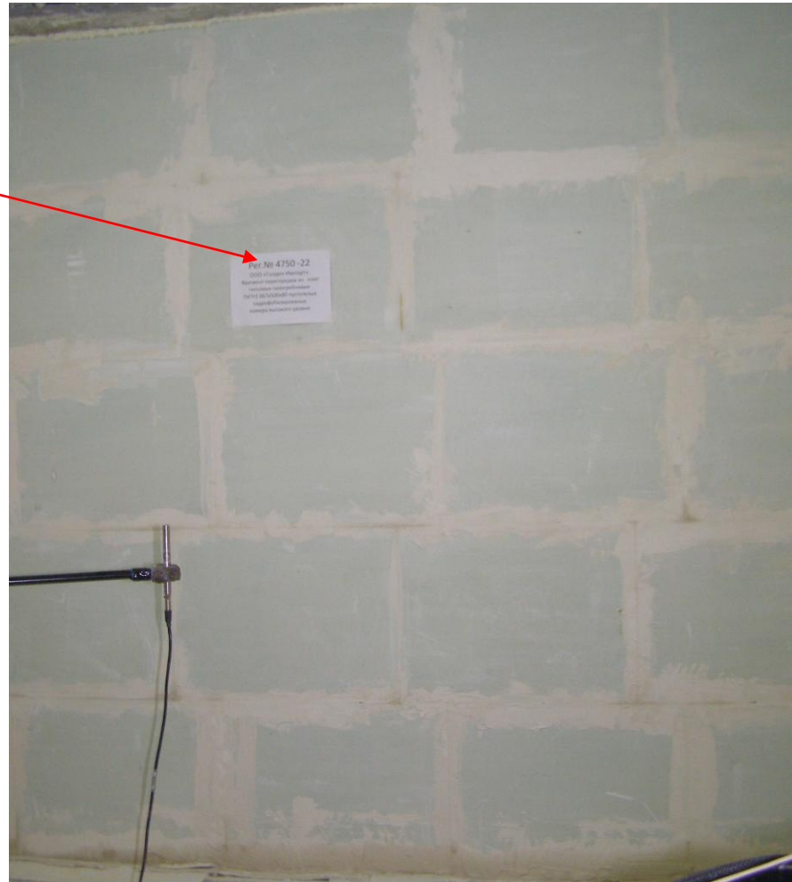
Фото 4. Камера высок. уровня, (испытание перегородки рег. № 4750-22 в акустической камере)
