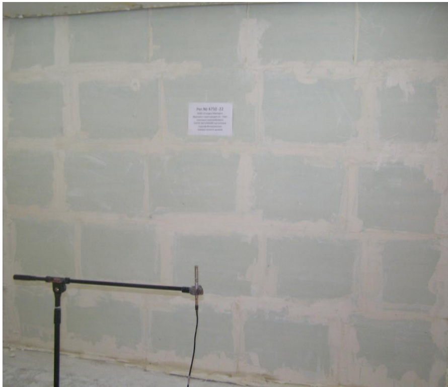
Фото 3. Камера низк. уровня, (испытание перегородки рег. № 4750-22 в акустической камере)
