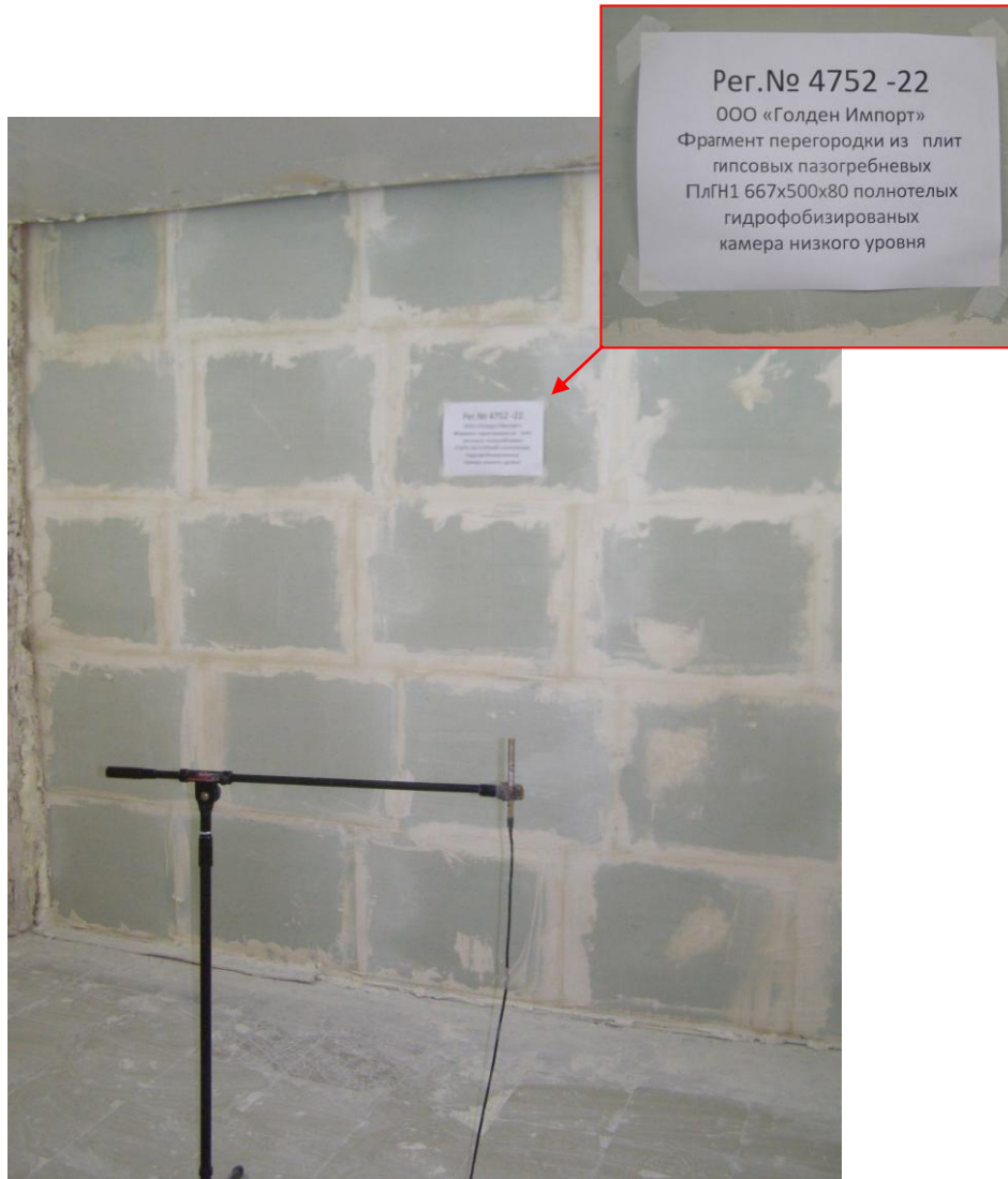
Фото 3. Камера низк. уровня, (испытание перегородки рег. № 4752-22 в акустической камере)
