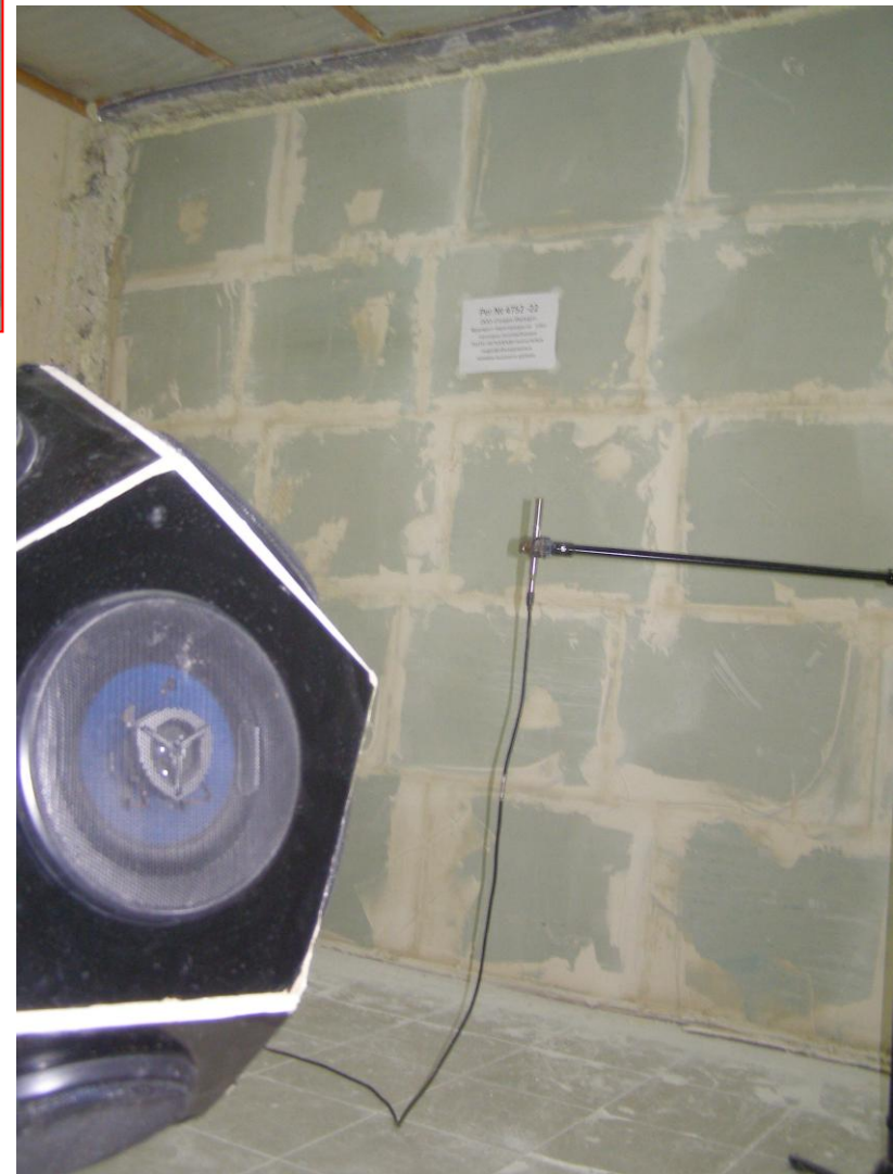
Фото 4. Камера высок. уровня, (испытание перегородки рег. № 4752-22 в акустической камере)
