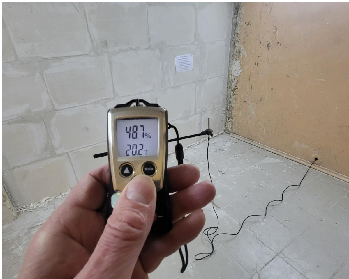
Фото 5. Испытания проводили при температуре окружающего воздуха 20,2°С и средней влажности 48,7 %
