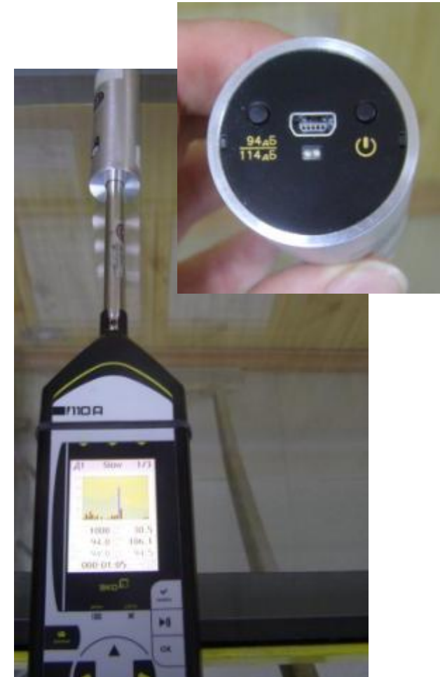
Фото 4. Калибровка шумомера при помощи калибратора акустического типа АК-1000
