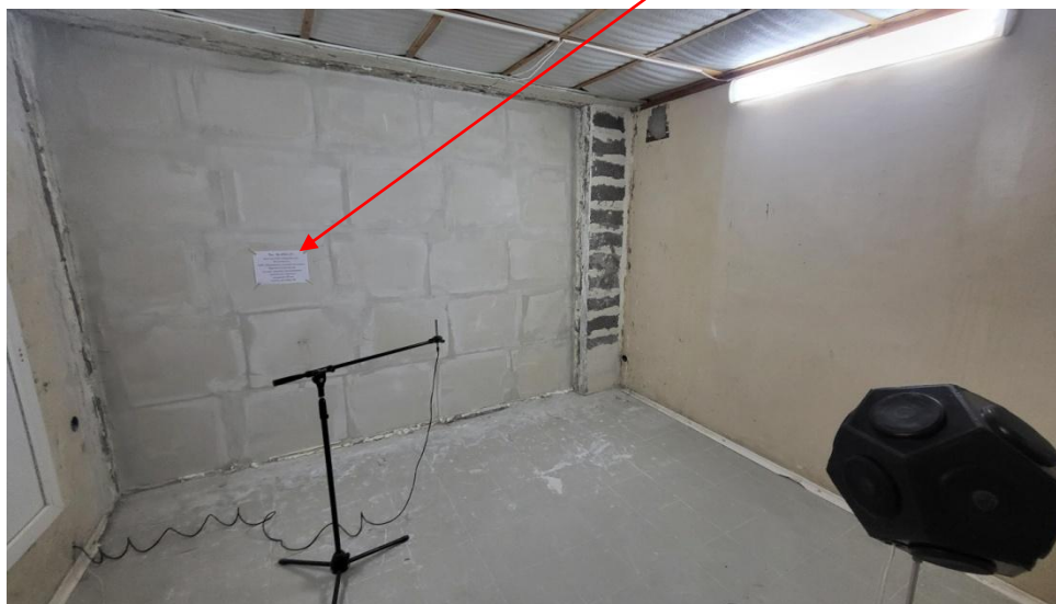
Фото 1. Камера высокого уровня, испытание фрагмента перегородки из плит гипсовых пазогребневых полнотелых ПлГН2 667x500x100 выложенных на монтажном гипсовом клее «ПЕРЛГИПС», толщина перегородки 100 мм Регистрационный № 4982-25 в акустической камере
