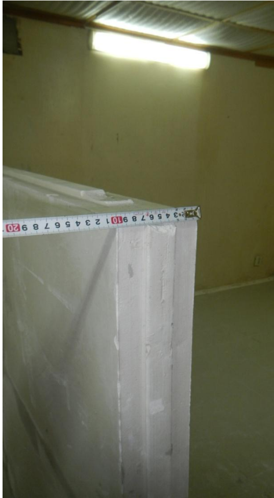
Фото 3. Толщина перегородки 100 мм. Регистрационный № 4982-25 в акустической камере
